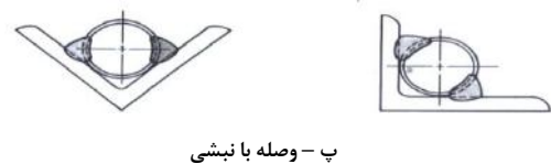
شکل ت ۵-۴ انواع اتصال با وصله جانبی
