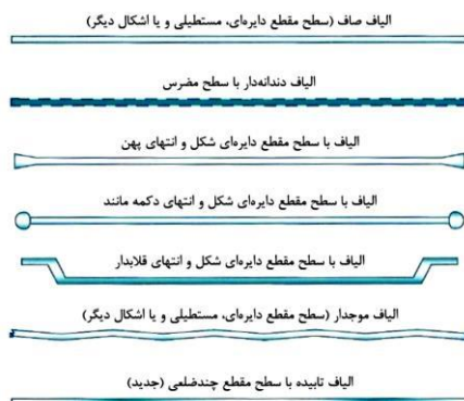
شکل ت ۳-۱ شکل برخی انواع الیاف
