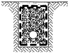
۶- اجرای خاکریز باقیمانده روی کانال و تراکم
