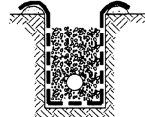
۴- ریختن مصالح زهکشی و تراکم
