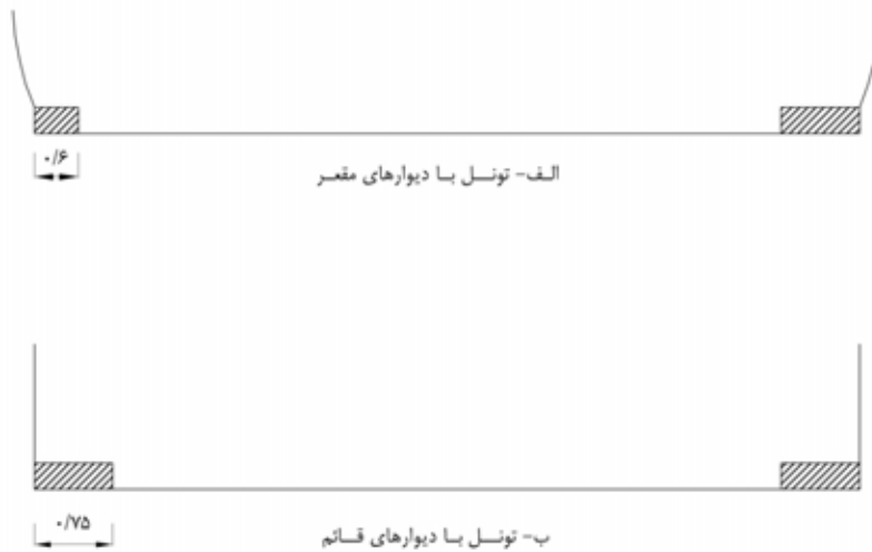
شکل ۶-۲۲- عرض پیاده‌روها با دیوارهای مختلف تونل
