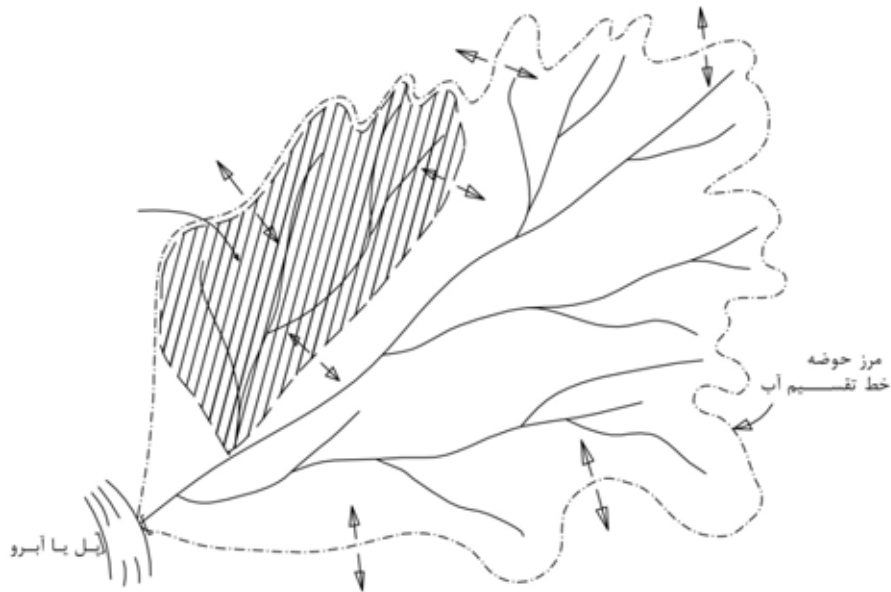
شکل ۱-۱-۱- تشکیل دبی سیلاب (رواناب سطحی) در یک حوزه آبریز بزرگ
